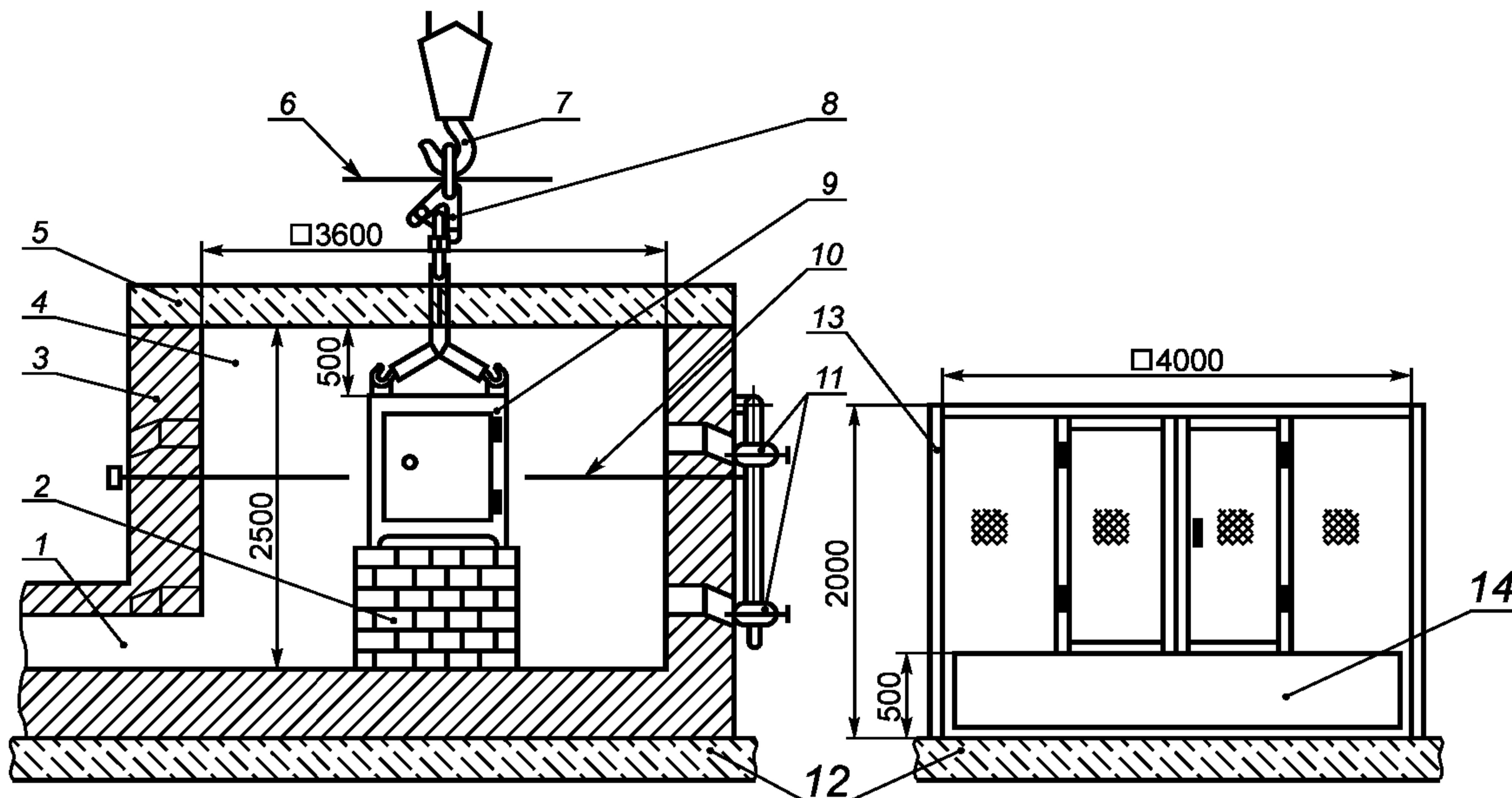
1 — дымовая труба; 2 — опора образца; 3 — кладка печи; 4 — огневая камера; 5 — перекрытие печи; 6 — защитный экран; 7 — подъемно-транспортное устройство; 8 — сбросное устройство; 9 — образец; 10 — термопары печные; 11 — форсунки; 12 — фундамент; 13 — защитное ограждение; 14 — гравийная подушка
