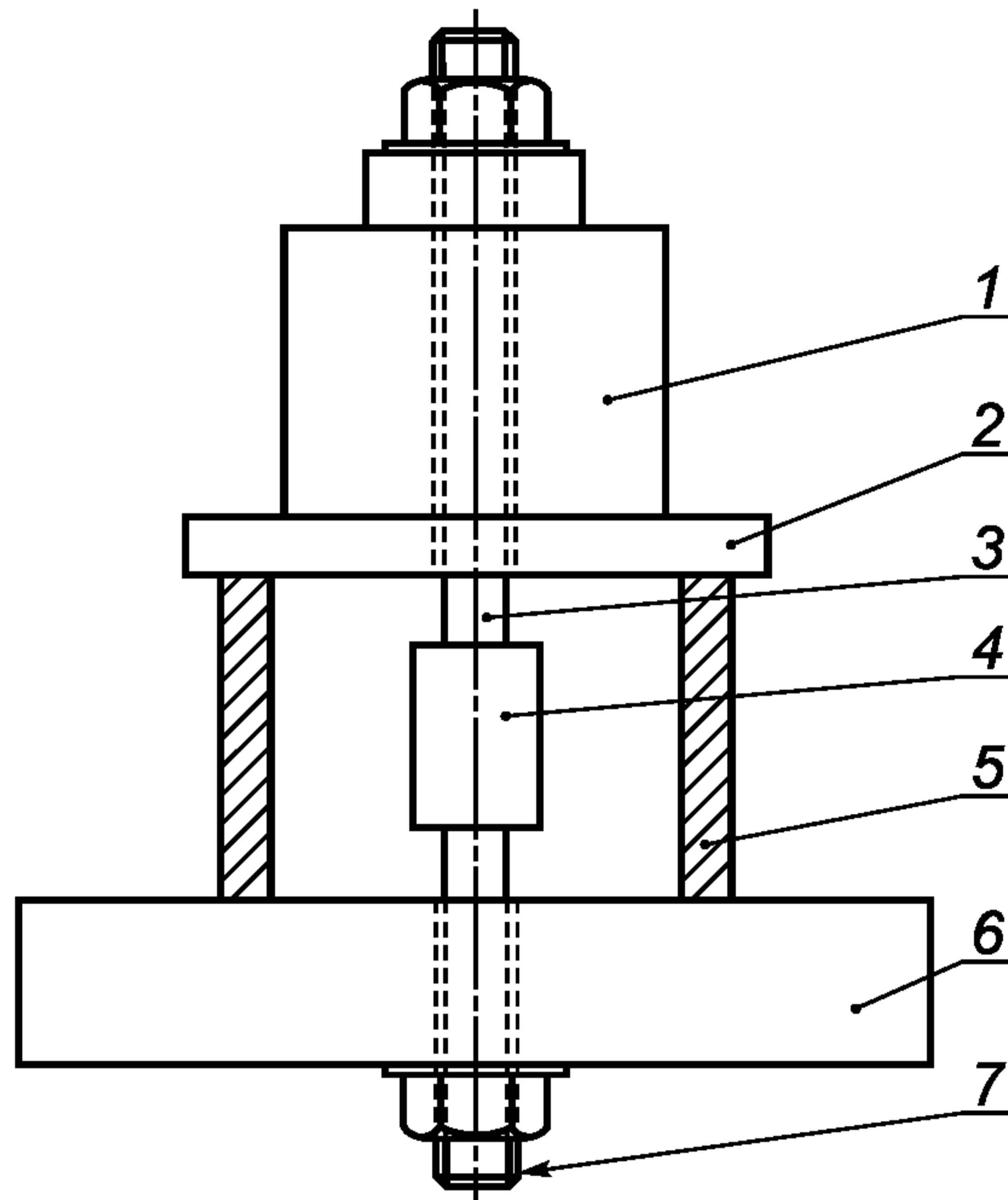
1 — домкрат; 2 — стальная опорная плита; 3 — узел крепления; 4 — переходник и блок измерения нагрузки; 5 — поддерживающий цилиндр внутренним диаметром  $2,5 d \pm 0,5 d$  ( $d$  — толщина стенки сейфа); 6 — стенка сейфа толщиной  $d$  (в мм) с анкерным отверстием; 7 — компоненты крепления в соответствии с описанием в инструкции по монтажу
